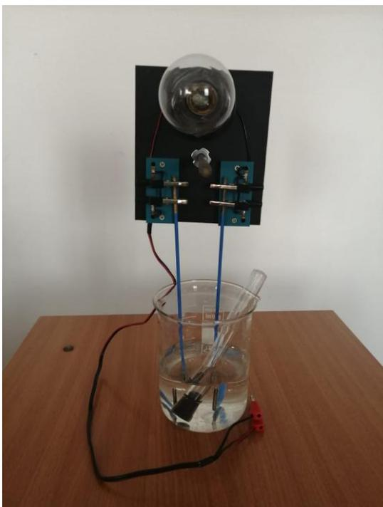
Прибор для проведения химических опытов с электрическим током
