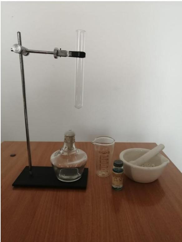
Установка для проведения химических опытов с реактивами при нагревании
