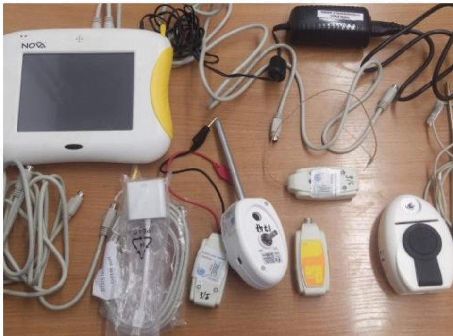
Цифровая лаборатория «Архимед» включает в себя: датчик ЭКГ, датчик давления, рН – метр, датчик содержания кислорода, магнитного поля, напряжения, датчик расстояния. Цифровые лаборатории «Архимед» представляют собой специальное оборудование, позволяющее сочетать натуральный эксперимент по физике, химии или биологии с преимуществами цифровой регистрации параметров этого эксперимента, когда измеряемые данные и результаты их обработки отображаются непосредственно на экране компьютера.
