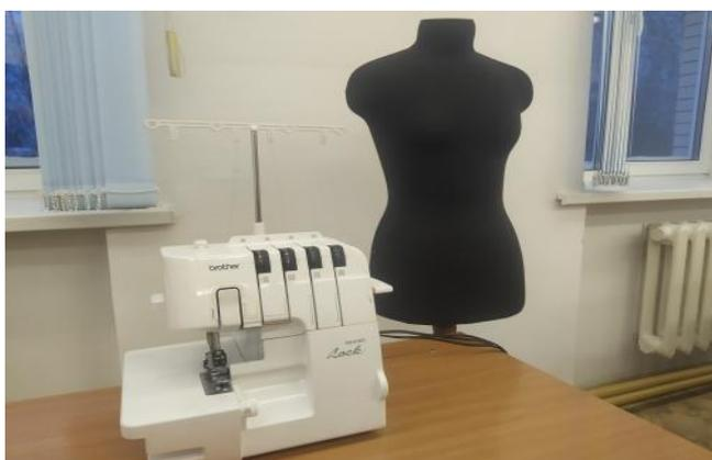
Рабочее место для обучающегося: манекен и машинка – оверлок. Манекен — лучший друг и боевой товарищ всех, кто занимается пошивом одежды. Хороший манекен будет помогать вам на каждом этапе: начиная от конструирования, заканчивая примеркой. Оверлок – особый вид швейной машины, созданный для обработки срезов текстильных материалов.
